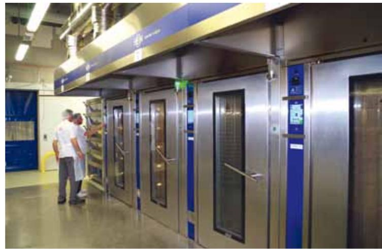
Ein massives Türsystem verschließt die Backkammer dampfdicht, Schwaden und Wärme bleiben im Ofen. Sämtliche wartungsempfindlichen Teile wie Brenner, Turbine oder Schaltkasten sind von vorn zugänglich.
