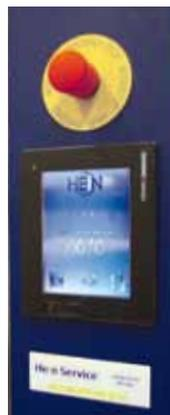
Das komplette System wird über einen großen Touchscreen gesteuert. Daran wird der Herd gewählt und das jeweilige Programm zum Besicken nach Beenden der Aufgabe gestartet. Frischprodukte backen bei 225 °C, vorgebackene Brote für die Tiefkühlung bei nur 205 °C.
