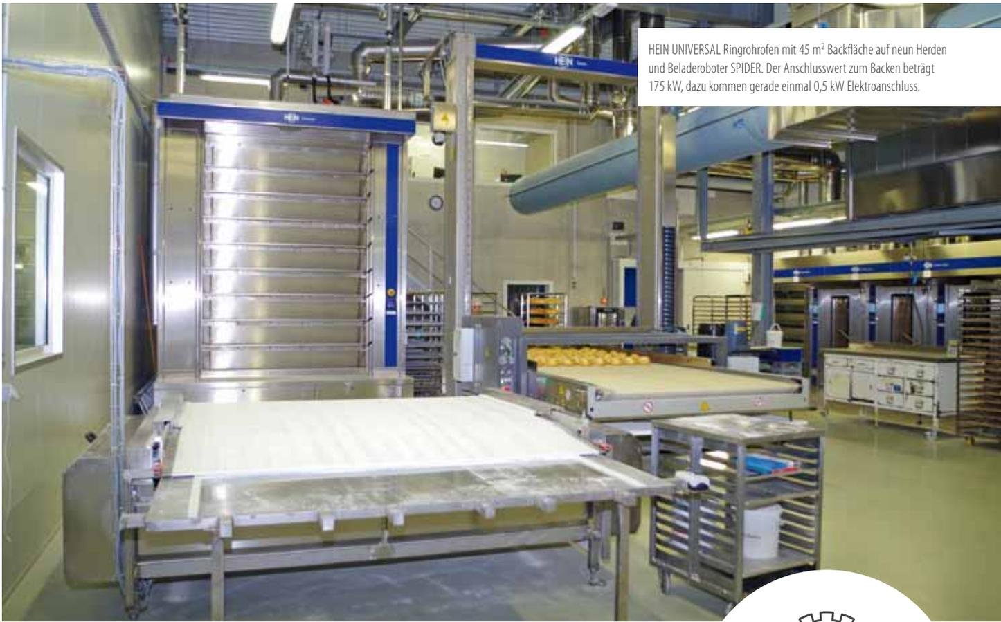
HEIN UNIVERSAL Ringrohröfen mit 45 m<sup>2</sup> Backfläche auf neun Herden und Beladeroboter SPIDER. Der Anschlusswert zum Backen beträgt 175 kW, dazu kommen gerade einmal 0,5 kW Elektroanschluss.
