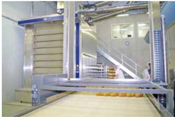
Einfahrt in den Herd. Die abgesenkte Spitze erleichtert das Absetzen der Teiglinge und spätere Aufkrabbeln der gebackenen Brote. Der SPIDER fährt die Brote nach Übernahme vom Aufgabebrett in die Herde ein, backt sie nach Ende der Backzeit aus und verfährt anschließend seitlich, damit die Brote abgenommen werden können.
