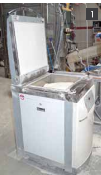
Beim Hydraulikteigteiler wird der Teig in die Kammer eingegeben, muss dann allerdings sorgfältig verteilt werden, um möglichst gleichmäßige Gewichte der einzelnen Teigstücke zu erreichen. Anschließend erfolgt das Teilen, indem Messer von unten in das Teigstück eindringen und es in 24 gleiche Portionen teilen. Das Gewicht der Teigstücke aus dem Hydraulikteiler schwankte um ca. 15 Gramm.
