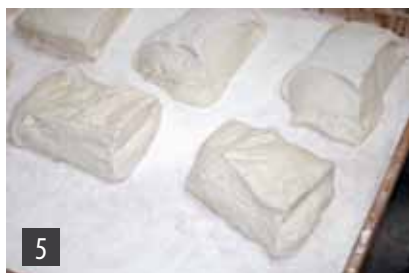
Beim Hydraulikteigteiler wird der Teig in die Kammer eingegeben, muss dann allerdings sorgfältig verteilt werden, um möglichst gleichmäßige Gewichte der einzelnen Teigstücke zu erreichen. Anschließend erfolgt das Teilen, indem Messer von unten in das Teigstück eindringen und es in 24 gleiche Portionen teilen. Das Gewicht der Teigstücke aus dem Hydraulikteiler schwankte um ca. 15 Gramm.
