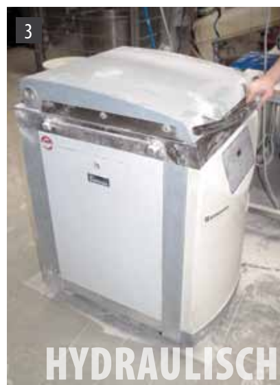
Beim Hydraulikteigteiler wird der Teig in die Kammer eingegeben, muss dann allerdings sorgfältig verteilt werden, um möglichst gleichmäßige Gewichte der einzelnen Teigstücke zu erreichen. Anschließend erfolgt das Teilen, indem Messer von unten in das Teigstück eindringen und es in 24 gleiche Portionen teilen. Das Gewicht der Teigstücke aus dem Hydraulikteiler schwankte um ca. 15 Gramm.
