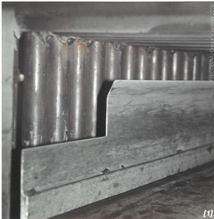
[1] Geräuschlos und ohne Pumpen steigt der Dampf in den Rohren auf und verteilt sich absolut gleichmäßig in dem geschlossenen System. [2] Jeder Herd besitzt separate Rohre für Ober- und Unterhitze, die im Gesamtkreislauf des Ringrohrsystems integriert sind. [3] Die Backprogramme und Temperaturkurven werden bei der neuen Steuerung Hein-Touchmatic in Form von Balken- und Kurvendiagrammen gespeichert und wiedergegeben. [4] Tartes sind das Aushängeschild des Konzepts Pain et Gâteau, von dem Krimphove in Münster mittlerweile drei Fachgeschäfte betreibt. [5] Herzhaft oder süß – die Auswahl an Tartes in den Fachgeschäften ist groß.
