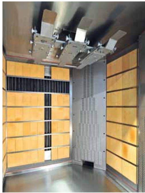
Die Rückwand aus Steinen im Stikkenofen bei HEIN: 77 Steine und 2,36 m 2 Abstrahlfläche im Ofen für einen Wagen, 119 Steine und 3,65 m 2 Fläche im doppelbreiten LUXROTOR. Die Masse zur Wärmerückgewinnung und -speicherung aus Wärmetauscher und Steinen besteht aus 207,5 kg im kleinen und 397 kg im größeren LUXROTOR.
