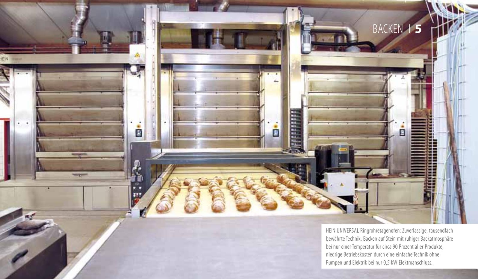
HEIN UNIVERSAL Ringrohröfen: Zuverlässige, tausendfach bewährte Technik, Backen auf Stein mit ruhiger Backatmosphäre bei nur einer Temperatur für circa 90 Prozent aller Produkte, niedrige Betriebskosten durch eine einfache Technik ohne Pumpen und Elektrik bei nur 0,5 kW Elektroanschluss.
