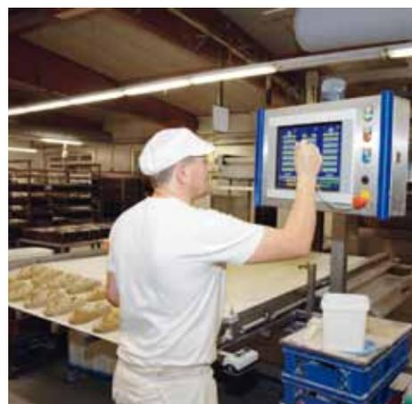
Die drei UNIVERSAL Ringrohröfen bieten jeweils 22 Quadratmeter Backfläche. Statt 4 x 110 kW wie bei den vier Heizgasumwälzöfen kommt man heute mit insgesamt 290 kW Anschlusswert aus, bei immerhin noch 8 Quadratmetern Backfläche mehr. Also ein Plus bei der Backfläche um circa 15 Prozent bei gleichzeitig 35 Prozent niedrigerem Anschlusswert. Außerdem konnte der Stromanschlusswert ebenfalls um 20 kW verringert werden.
