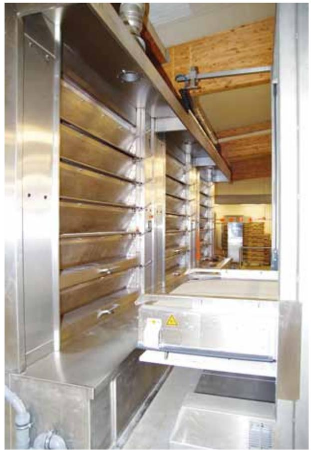
Am Aufgabertisch wird nicht mehr wie noch beim alten System mit Querabziehern gearbeitet, sondern mit leichten Peelboards. Der solide und vielfach bewährte Be- und Entladeroboter SPIDER verfährt ohne Käfig vor den drei Öfen. Bei jedem Ausbacken saugt ein Staubsauger automatisch den Herd ab.
