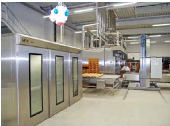
HEIN lieferte neben der Ofenanlage mit zwei UNIVERSAL Ringrohretagenöfen mit halb-automatischem Beladeroboter SPIDER und zwei ECOSTONE 2 Stikkenbacköfen auch den Gärraum. Der ist leicht demontierbar, so dass bei Bedarf noch ein weiterer Etagenöfen Platz hätte.
