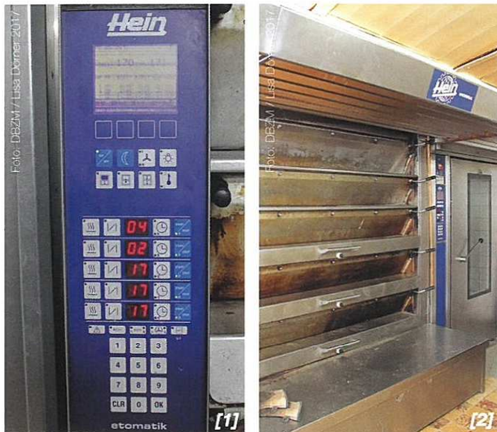
[1] Die Folientastatur wird bei neuen Öfen durch Touchpads ersetzt. Da aber keine komplizierten Backkurven bei diesem Ofentyp notwendig sind, ist diese Steuerung ausreichend. [2] Der Universal wird durch ein Stikkenofen ergänzt.
