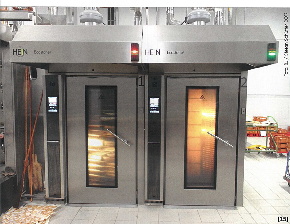
[15] Beim EcoStone 2 konnte Hein die Brennerlaufzeit, im Vergleich zu einem normalen Stikkenofen, um rund fünf Prozent und den Anschlusswert um zehn Prozent senken. [16] Die moderne Touchscreen-Steuerung des EcoStone 2 mit Piktogrammen für jedes Programm ist intuitiv bedienbar. [17] Weil die Thermosteinwand die entweichende Hitze schneller ersetzt, fällt beim EcoStone 2 die Temperatur beim Beschicken und Ausbacken im Durchschnitt um 20 Grad Celsius weniger ab. [18] Die Thermosteinwand im EcoStone 2 besteht aus 77 Steinen. Sie stellt der integrierten Wärmerückgewinnung eine Abstrahlfläche von 2,36 Quadratmetern bereit.
