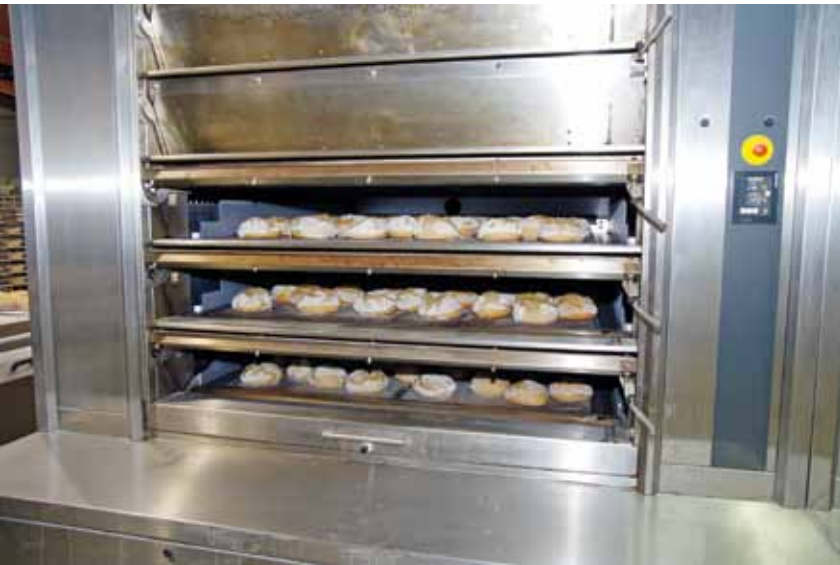
Die automatische Klappenöffnung unterstützt die Schwadenentlastung, wichtig vor allem auch bei stark roggenhaltigen Produkten. Nach dem Ausbacken fährt der SPIDER, wie im Programm hinterlegt, zur Übergabestation. Auch eine Zwischenkontrolle oder ein zwischenzeitliches Absprühen mit anschließendem Weiterbacken lässt sich programmieren.
