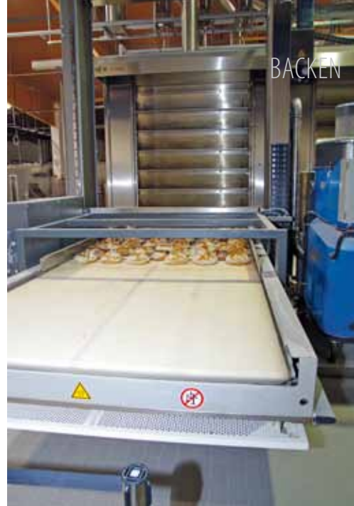
Die automatische Klappenöffnung unterstützt die Schwadenentlastung, wichtig vor allem auch bei stark roggenhaltigen Produkten. Nach dem Ausbacken fährt der SPIDER, wie im Programm hinterlegt, zur Übergabestation. Auch eine Zwischenkontrolle oder ein zwischenzeitliches Absprühen mit anschließendem Weiterbacken lässt sich programmieren.
