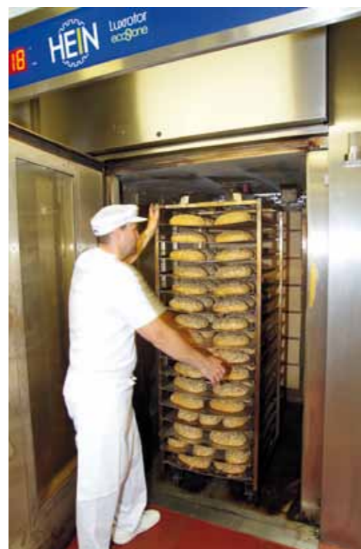
FlexBaker UV in der Praxis. Die Produkte werden normal aufgearbeitet, zu ca. 80 Prozent gebacken und in die FlexBaker UV-Zelle geschoben. Die Lagerdauer kann problemlos bis auf 21 Tage ausgedehnt werden, eine mikrobielle Belastung der Backwaren verhindert die UV-Technologie. Bei Bedarf werden Brote oder Kleingebäcke fertig gebacken. Die Ergebnisse sind überzeugend. Kein Austrocknen, ein überragender Frischeindruck, bester Geschmack.
