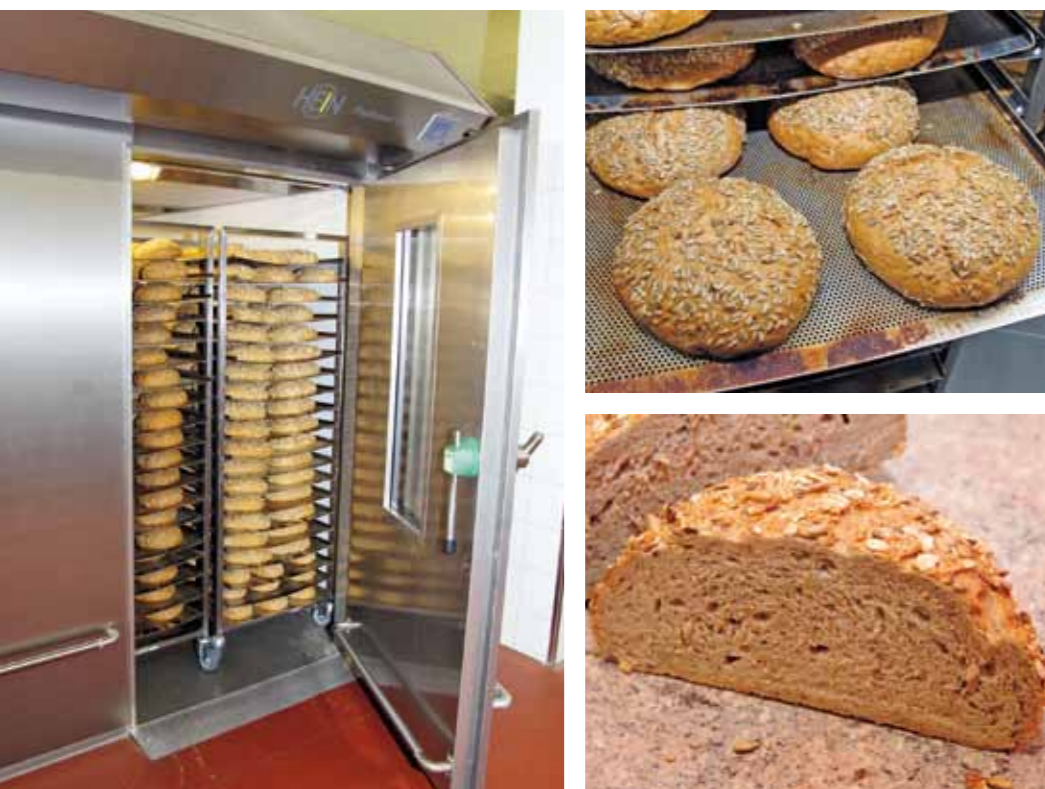
FlexBaker UV in der Praxis. Die Produkte werden normal aufgearbeitet, zu ca. 80 Prozent gebacken und in die FlexBaker UV-Zelle geschoben. Die Lagerdauer kann problemlos bis auf 21 Tage ausgedehnt werden, eine mikrobielle Belastung der Backwaren verhindert die UV-Technologie. Bei Bedarf werden Brote oder Kleingebäcke fertig gebacken. Die Ergebnisse sind überzeugend. Kein Austrocknen, ein überragender Frischeindruck, bester Geschmack.
