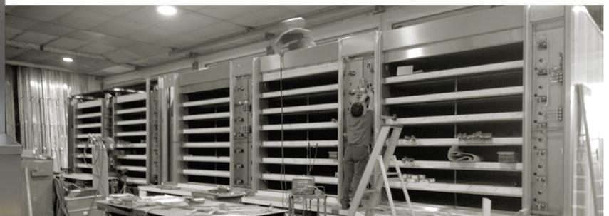
**MAßGESCHNEIDERTER ANLAGENBAU MIT UNIVERSAL PLUS RINGROHRÖFEN**
