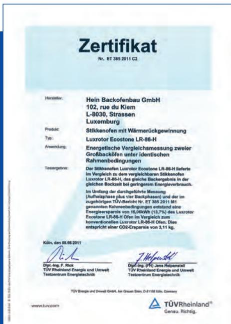
Nicht so bei dem neuen HEIN ECOSTONE® System: hierbei handelt es sich lediglich um eine zusätzliche mechanische Wärmerückgewinnung kombiniert mit einem aktiven Thermosteinspeicher von 200 kg, welcher mindestens die gleiche Lebensdauer hat wie der bewährte Wärmetauscher in der Feuerung.
