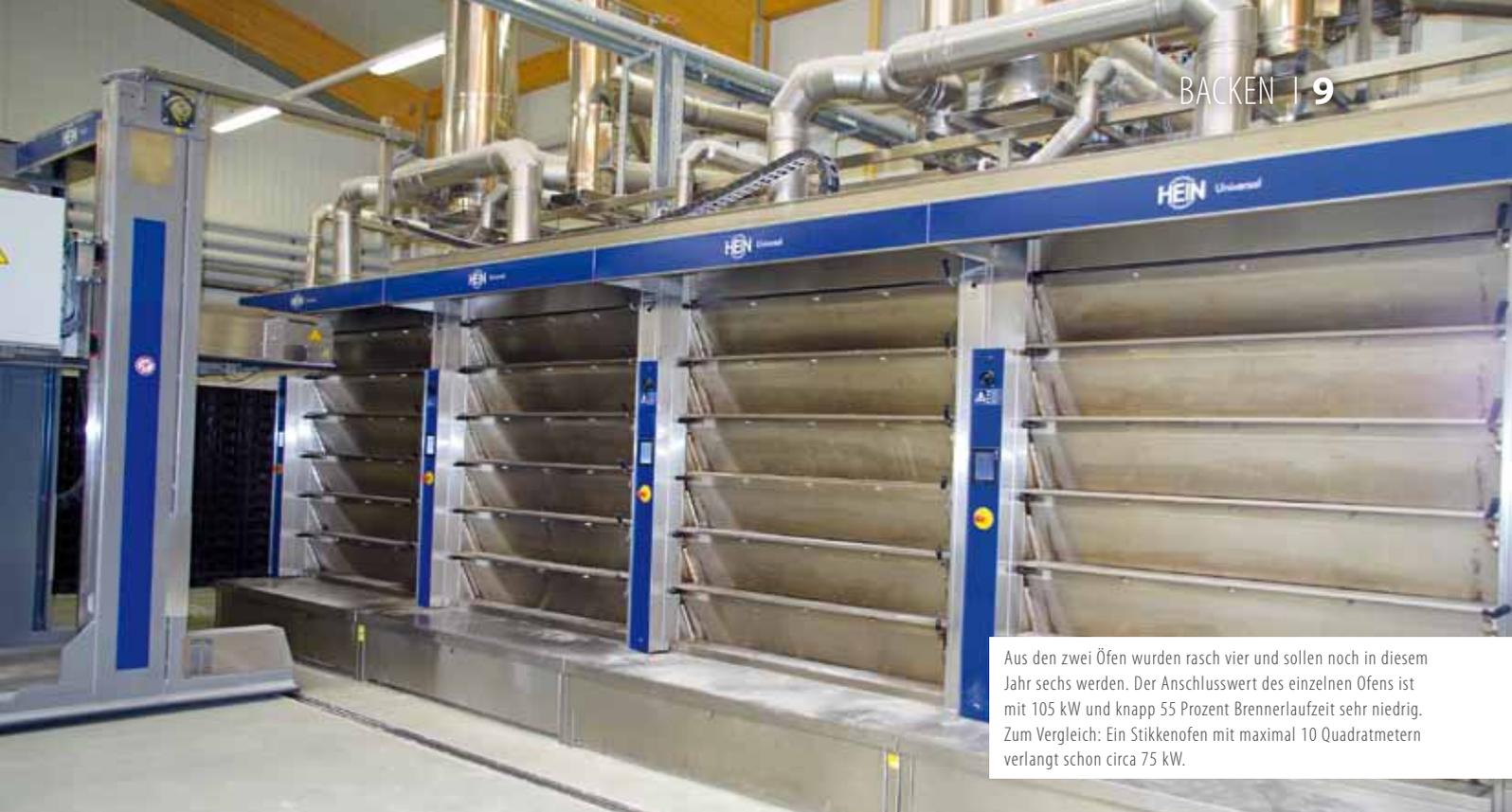
Aus den zwei Öfen wurden rasch vier und sollen noch in diesem Jahr sechs werden. Der Anschlusswert des einzelnen Ofens ist mit 105 kW und knapp 55 Prozent Brennerlaufzeit sehr niedrig. Zum Vergleich: Ein Stikkenofen mit maximal 10 Quadratmetern verlangt schon circa 75 kW.
