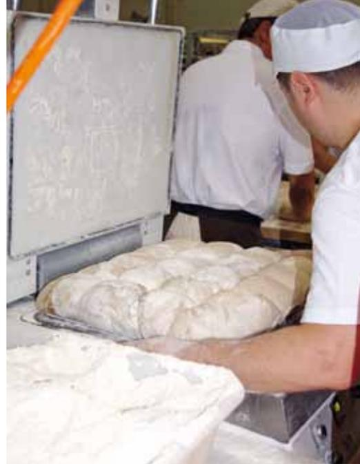
Der Teig für das Huus Brot ist mit einer TA von 185 bis 190 recht weich. Er wird zu je 12 kg in Boxen abgewogen. Nach einer Lagerzeit von bis zu 24 Stunden teilt ein Hydraulikteiler die 12 kg dann in einer 20er Teilung in 20 Brote mit 600 g Einwaage.
