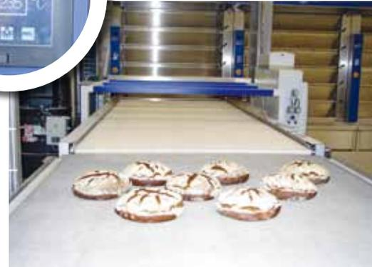
Die Öfen werden über den SPIDER Beladeroboter mit integriertem Staubsauger beschickt und ausgebacken. Auch hier wird der Qualitätsgedanke wieder deutlich, denn nach jedem Backgang wird der Ofen nicht nur automatisch mit dem Ausbacken der Produkte ausgesaugt, sondern anschließend noch einmal im Leerbetrieb. Von Sonntag bis Samstag haben die Öfen nur eine Temperatur: 235°C.
