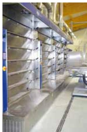
Hasel wollte die sechsherdige Ausführung des UNIVERSAL und verzichtet damit bewusst auf größere Öfen mit bis zu zehn Etagen und entsprechend mehr Backfläche. Die gesamte Anlage steht in einem Käfig und besteht aktuell aus vier UNIVERSAL Ringrohröfen mit je 22 Quadratmetern Backfläche, sechsherdig, dreifachbreit und zwei Meter tief, sowie einem SPIDER Beladeroboter, einem Übergabe- und einem Ausbacktisch.
