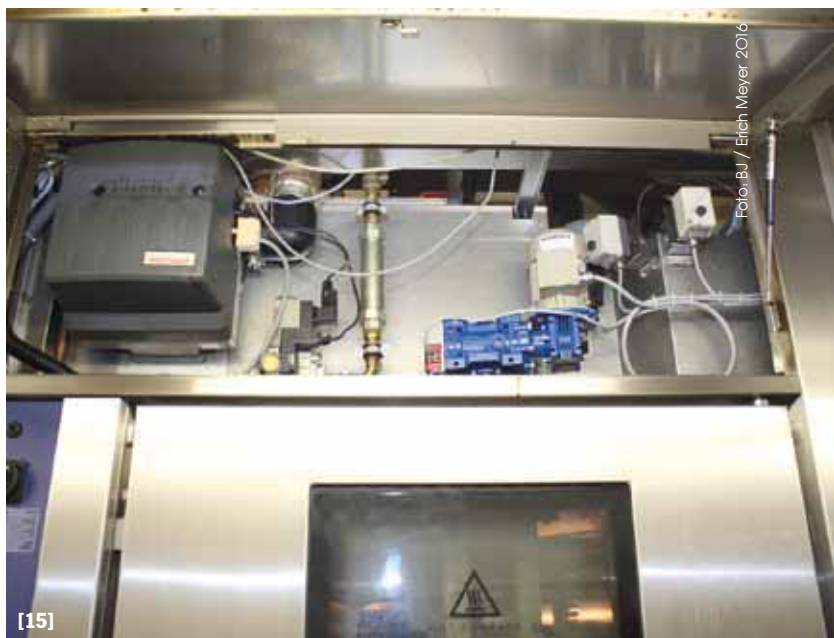
[13] Durch diese Druckwand gelangt die vom darüberliegenden Wärmetauscher erzeugte Backluft in die Backkammer. Dahinter ist die Kaskaden-Schwadenanlage angeordnet, die vom Heißluftstrom mitbeheizt wird. [14] Die Beleuchtung der Backkammer erfolgt über solche Glasfaser-Spots, die von einem Halogenstrahler gespeist werden. [15] Alle wartungsrelevanten Bauteile, wie beispielsweise Gasbrenner oder Stikkenantrieb, sind leicht erreichbar hinter einer großen Haube untergebracht.
