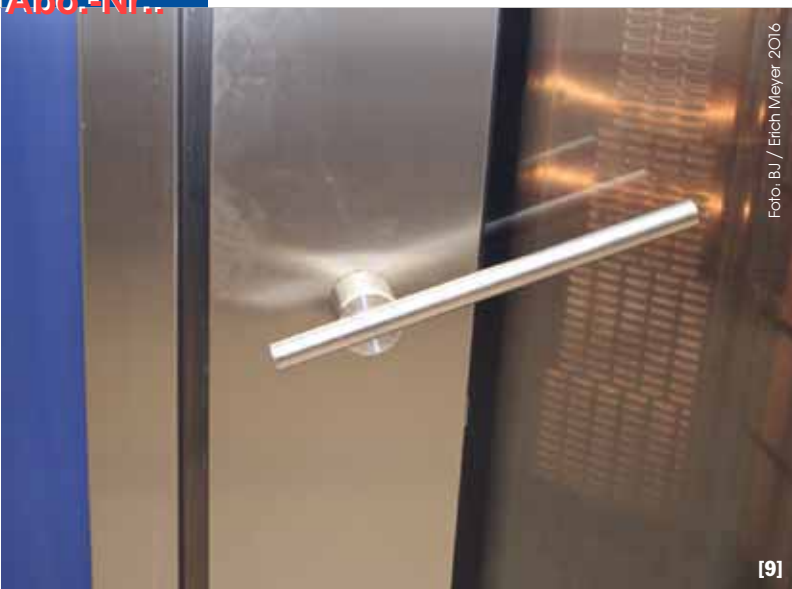
[9] Die Ofentür ist mit einem innenliegenden Mechanismus ausgestattet, der sie mit dem Herunterdrücken dieses Handhebels mit wenig Kraftaufwand komplett anhebt. [10-11] Sowohl an der Schlosssäule als auch am Türblatt befinden sich oben und unten jeweils zwei solcher justierbarer Keilpaare aus massivem Edelstahl. [12] Diese greifen beim Schließen und Absenken der Tür ineinander und pressen sie fest an die Dichtfläche, sodass nahezu kein Dampf mehr aus der Backkammer entweicht.
