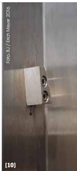
[9] Die Ofentür ist mit einem innenliegenden Mechanismus ausgestattet, der sie mit dem Herunterdrücken dieses Handhebels mit wenig Kraftaufwand komplett anhebt. [10-11] Sowohl an der Schlosssäule als auch am Türblatt befinden sich oben und unten jeweils zwei solcher justierbarer Keilpaare aus massivem Edelstahl. [12] Diese greifen beim Schließen und Absenken der Tür ineinander und pressen sie fest an die Dichtfläche, sodass nahezu kein Dampf mehr aus der Backkammer entweicht.
