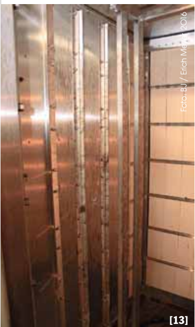
[13] Durch diese Druckwand gelangt die vom darüberliegenden Wärmetauscher erzeugte Backluft in die Backkammer. Dahinter ist die Kaskaden-Schwadenanlage angeordnet, die vom Heißluftstrom mitbeheizt wird. [14] Die Beleuchtung der Backkammer erfolgt über solche Glasfaser-Spots, die von einem Halogenstrahler gespeist werden. [15] Alle wartungsrelevanten Bauteile, wie beispielsweise Gasbrenner oder Stikkenantrieb, sind leicht erreichbar hinter einer großen Haube untergebracht.
