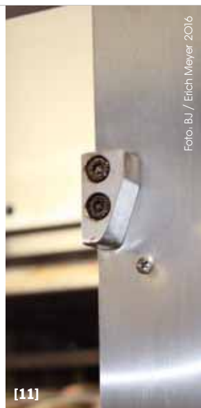
[9] Die Ofentür ist mit einem innenliegenden Mechanismus ausgestattet, der sie mit dem Herunterdrücken dieses Handhebels mit wenig Kraftaufwand komplett anhebt. [10-11] Sowohl an der Schlosssäule als auch am Türblatt befinden sich oben und unten jeweils zwei solcher justierbarer Keilpaare aus massivem Edelstahl. [12] Diese greifen beim Schließen und Absenken der Tür ineinander und pressen sie fest an die Dichtfläche, sodass nahezu kein Dampf mehr aus der Backkammer entweicht.
