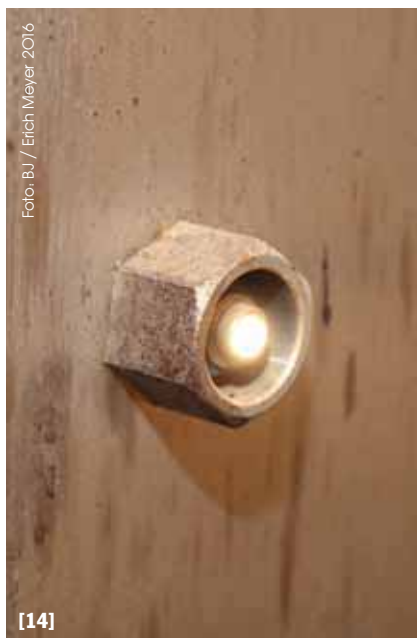
[13] Durch diese Druckwand gelangt die vom darüberliegenden Wärmetauscher erzeugte Backluft in die Backkammer. Dahinter ist die Kaskaden-Schwadenanlage angeordnet, die vom Heißluftstrom mitbeheizt wird. [14] Die Beleuchtung der Backkammer erfolgt über solche Glasfaser-Spots, die von einem Halogenstrahler gespeist werden. [15] Alle wartungsrelevanten Bauteile, wie beispielsweise Gasbrenner oder Stikkenantrieb, sind leicht erreichbar hinter einer großen Haube untergebracht.
