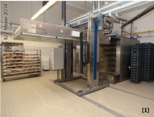
[1] Alle freigeschobenen Brote werden im sechsherdigen Universal Ringrohrföfen auf einer Backfläche von knapp 22 m 2 gebacken. Er verfügt über eine gemauerte Steinföherung und wurde komplett montiert in die Backstube eingebracht. Die erweiterten Laufschienen des halbautomatischen Laderoboters Spider lassen erahnen, dass hier noch ein zweiter Ofen folgen soll. [2] Das Beschicken und Entladen des Etagenofens ist dank des Spiders problemlos durch einen Mitarbeiter zu bewältigen. Das Einschießen und Ausbacken erfolgt durch ein einziges, hitzefestes Band. [3] Hein lieferte auch den vollklimatisierten Gärschrank namens Toplux.
