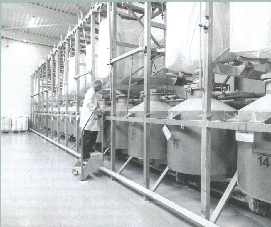
Big bags vol zaden en pitten hangen gescheiden van elkaar boven silo's, waaruit volledig geautomatiseerd een mix naar de kneders wordt gezogen.
