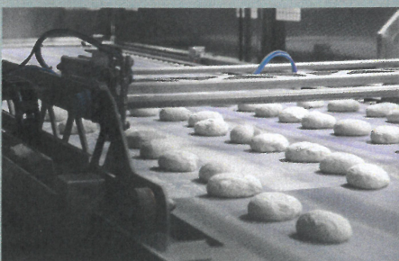
Van de nieuwste broodlijn in Stadskanaal rollen zowel diepgevroren deegstukken als ook half- of volledig afgebakken broden. Een deel van de deegstukken gaat rechtstreeks de vriezer in. Een ander deel gaat de stenen vloeroven in.
