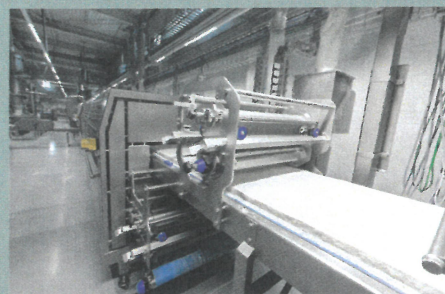
Het deeg is aanvankelijk 60 centimeter breed en wordt verderop in de lijn uitgerold tot het dubbele. Hiervan worden uiteindelijk vier deegstromen gemaakt.
