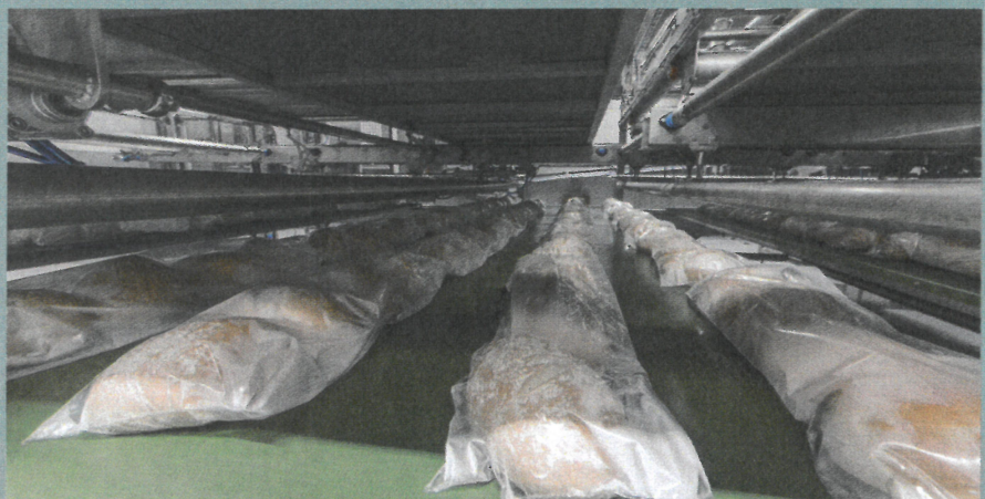
De broden komen elkaar weer tegen op weg naar de verpakingslijn. Hier worden zowel half- of volledig afgebakken en diepgevroren broden in plastic verpakt. Volgens Borgesius is het juist goed om ook warme broden direct in afgesloten plastic te verpakken. De condens in de zak trekt vanzelf opnieuw in de korst en blijft zodoende in het brood.
