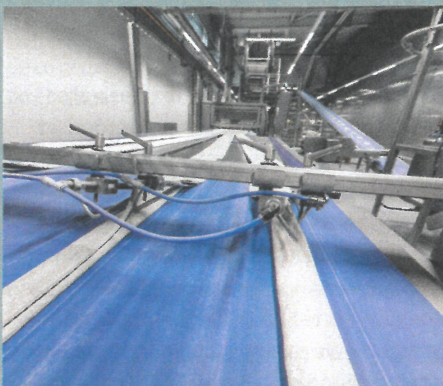
Het deeg wordt machinaal gevouwen met behulp van stromende lucht, zodat het deeg niet aan de machine blijft plakken. Afsnijdsels gaan via een lopende band terug naar de deegkuip boven. Hier wordt nauwkeurig afgewogen hoeveel afsnijdsel aan het volgende deeg wordt toegevoegd. Ook dit gebeurt allemaal automatisch.
