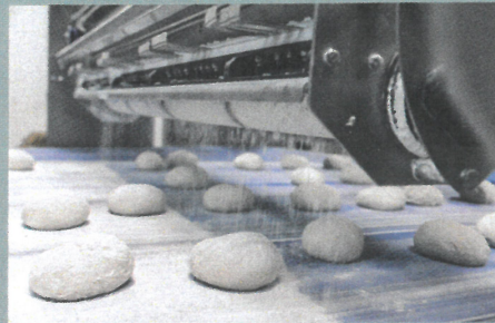
De bloem waarmee het deeg wordt bestoven, valt iets verderop in een opvangbak en wordt gerecycled.
