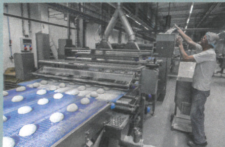
De bloem waarmee het deeg wordt bestoven, valt iets verderop in een opvangbak en wordt gerecycled.
