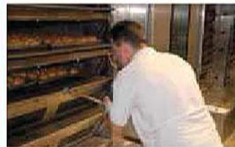
Mit einer Hakenstange lassen sich die hinteren Bleche zum Ausbacken nach vorne ziehen.
