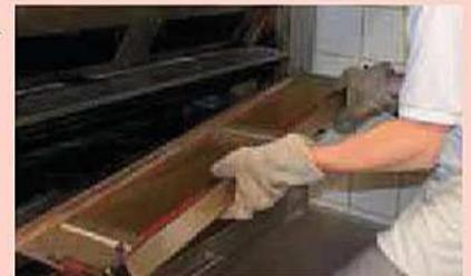
Zur Reinigung der Glasscheiben werden die Klappen alle sechs Monate ausgebaut und nach dem Abkühlen im Spülbecken mit einem Fettlöser gesäubert.
