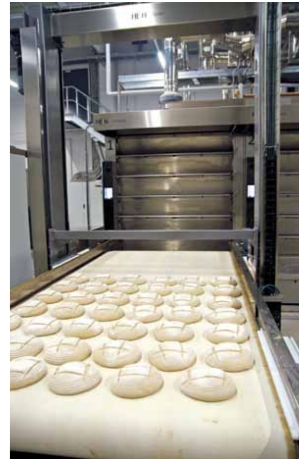
Der Beschickungshalbautomat SPIDER fährt die Brote in den an der Touchscreen Steuerung vorgewählten Herd ein und zieht sie schonend auf die Herdplatte ab. Am Ende der gewählten Backzeit wird der Lader wieder auf die entsprechende Herdposition gefahren, und krabbelt das Brot im Herd auf. Auf Knopfdruck verfährt der Spider seitlich zum Übergabetisch.
