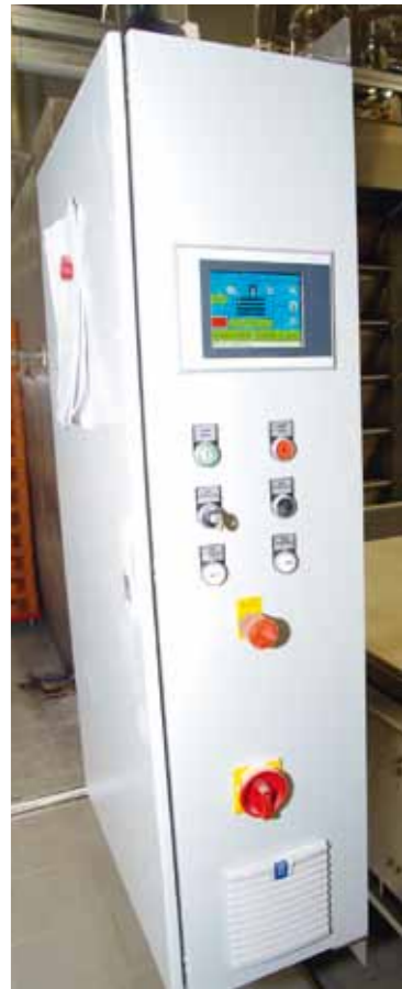
Der Beschickungshalbautomat SPIDER fährt die Brote in den an der Touchscreen Steuerung vorgewählten Herd ein und zieht sie schonend auf die Herdplatte ab. Am Ende der gewählten Backzeit wird der Lader wieder auf die entsprechende Herdposition gefahren, und krabbelt das Brot im Herd auf. Auf Knopfdruck verfährt der Spider seitlich zum Übergabetisch.
