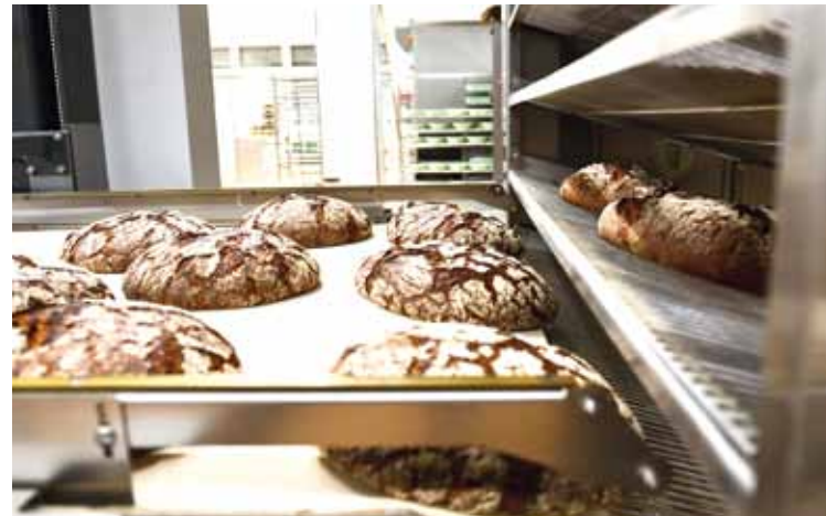
Langsam gleiten die Brote vom Spider in die Auskühlregale, mit denen sie in den Versand geschoben werden.
