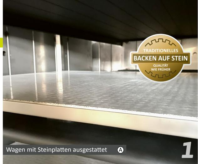
Wagen mit Steinplatten ausgestattet (A)
